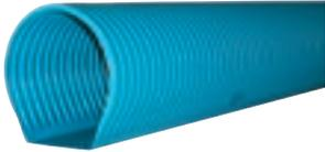
Teilsicker- und Mehrzweckrohre aus PVC-U nach DIN 4262-1 Typ C1 (vormals Form F), Wassereintrittsfläche  $\geq 50 \text{ cm}^2/\text{m}$ , Schlitzbreite  $1,2 \text{ mm} \pm 0,4 \text{ mm}$ . Entsprechend REwS (Richtlinien für die Entwässerung von Straßen) einsetzbar, SN 4 nach DIN EN ISO 9969.
