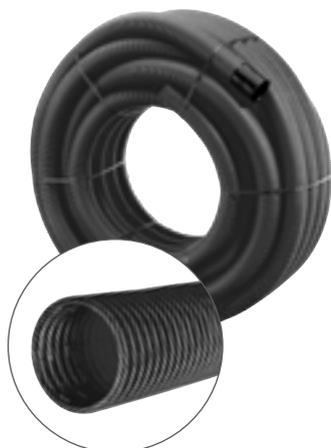
Gewelltes Vollsickerrohr aus PE; Farbe schwarz mit gelber Farbmarkierung; Ringsteifigkeitsklasse SN 8; Schlitzfläche  $\geq 50 \text{ cm}^2/\text{m}$ ; Schlitzbreite 1,2 mm. In Anlehnung an DIN 1187 und DIN 4262-1.
