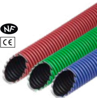
Kabelschutzrohr aus PE in Verbundrohrbauweise (außen gewellt, innen glatt) nach DIN EN 61386-24 mit Muffe (sanddichte Ausführung), halogenfrei, Sonderfarben. Hohe Scheiteldruck- und Schlagfestigkeit sowie Biegefähigkeit. Druckbeanspruchung Typ 450, Klassifizierungscode N450. Doppelsteckmuffen (DSM) für sanddichte Verbindungen (SD). Mit Profildichtringen wasserdichte Verbindung (WD).
