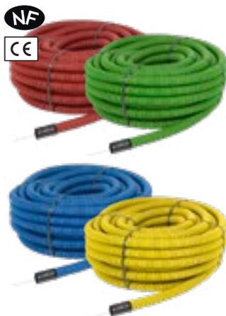
Kabelschutzrohr aus PE in Verbundrohrbauweise (außen gewellt mit Innenrohr) nach DIN EN 61386-24 mit Muffe (sanddichte Ausführung), halogenfrei, Sonderfarben. Flexibel, in Ringen, mit Einzugsschnur. Hohe Scheiteldruck- und Schlagfestigkeit sowie Biegefähigkeit. Druckbeanspruchung Typ 450, Klassifizierungscode N450. Doppelsteckmuffen für sanddichte Verbindungen (SD). Mit Profildichtringen wasserdichte Verbindung (WD).
