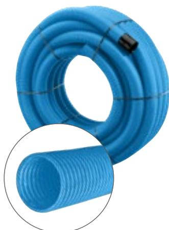
Gewelltes ungelochtes Dränagerohr aus PP; Farbe blau; Ringsteifigkeit  $\geq 10 \text{ kN/m}^2$  („SN 10“); in Anlehnung an DIN 1187 und DIN 4262-1.
