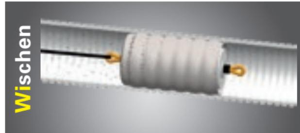
Der zweite Schritt des Wischens sorgt für eine gründliche Reinigung der Rohrleitung.
