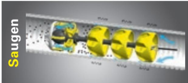
Bereits beim Einsaugen der Zugeinheit wird Schmutz und Staub mittels eines handelsüblichen Staubsaugers gelöst und abgesaugt.
