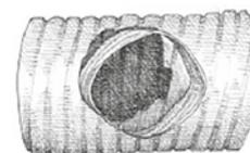
Mauvais raccordement qui réduit le débit du drain et qui peut bloquer des racines
