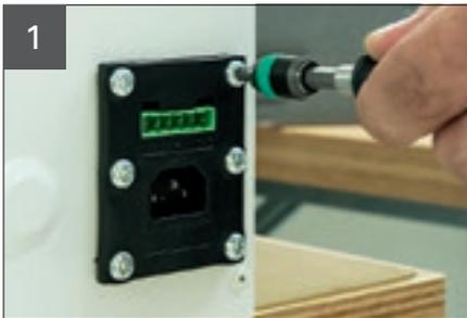
Lösen der 6 Schrauben am Anschlussfeld.
