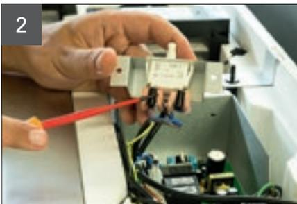
Lösen der Klemmen auf der Rückseite des Sicherheitsschalters.
