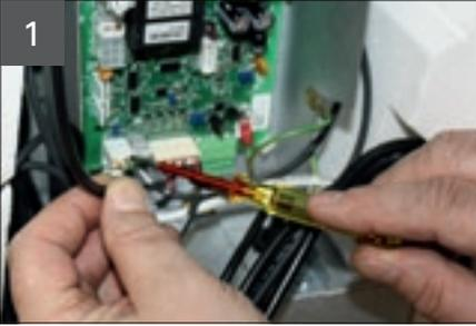
Klemme J14 - Feuchtesensor Abluft lösen.
