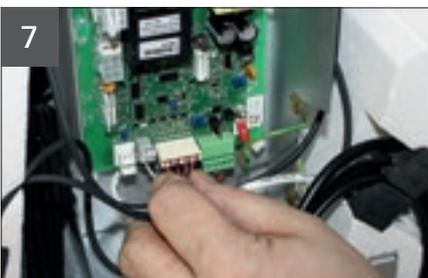
Klemme J7 - Temperatursensoren lösen.
