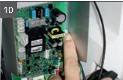
Die 5 Befestigungsclips vorsichtig lösen, Platine entfernen.
