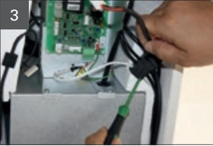
Kabel des Stellantriebes entfernen.
