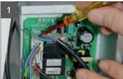
Klemme J1 - AC Netzspannung (230 VAC) lösen.
