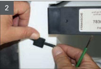
Kabel aus der Kabelführung lösen.
