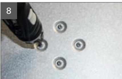
4 Befestigungsschrauben des Ventilator auf der Rückseite des Ventilatorgehäuses lösen.
