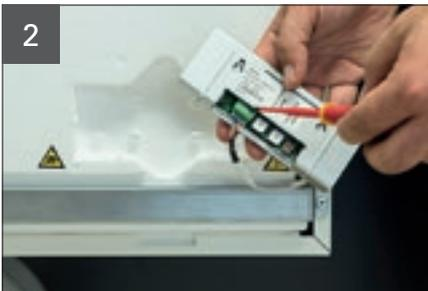
Rückseitige Abdeckung der Bedieneinheit öffnen.
