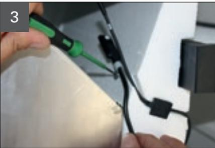
Klemmschelle mit Schraubendreher lösen.
