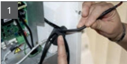
Zuerst müssen die folgenden Anschlüsse auf der Steuerplatine gelöst werden:
