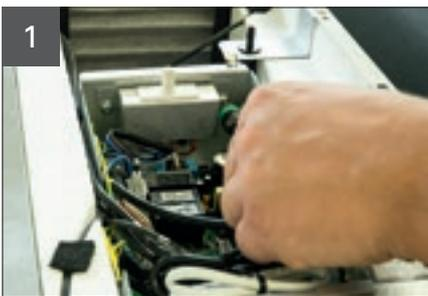
Lösen der beiden Schrauben am Befestigungsblech.
