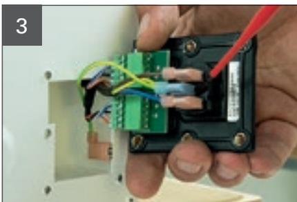
Stromleitung am Anschlussfeld lösen.
