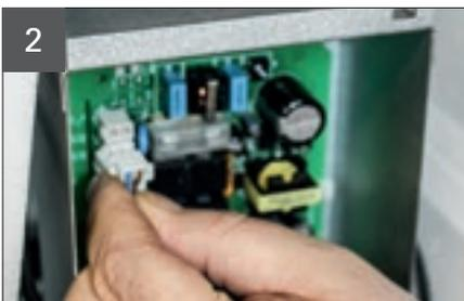
Klemme J3 - Netzanschluss Fortluftventilator (230 VAC) lösen.
