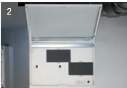
Obere Frontblende nach oben aufklappen und Stütze links in Gehäuseseitenwand einrasten lassen.
