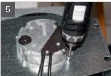
5 4 Befestigungsschrauben des Ventilators vom Befestigungsbügel lösen.
