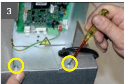
Lösen der 2 Gehäuseschrauben.
