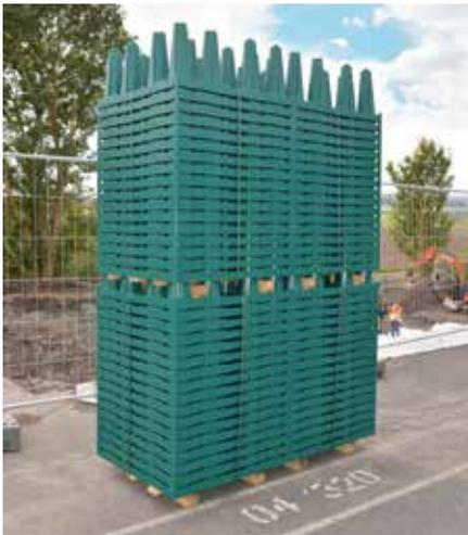
Rigofill ST-A kann im Freien gelagert werden. Die Lagerzeit im Freien darf jedoch **ein Jahr** nicht überschreiten, wobei das Material vor direkter Sonneneinstrahlung zu schützen ist (z. B. durch Lagerung im Schatten oder Abdecken mit heller, lichtundurchlässiger Folie).
