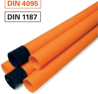
Stangendränrohr aus PVC-U nach DIN 4095; Mindestwassereintrittsfläche 80 cm<sup>2</sup>/m; flexibel und gütegesichert; Farbe orange; Einzellänge 2,50 m mit einseitig aufgesteckter Muffe.
