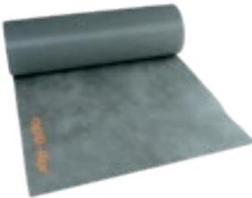
Mechanisch verfestigter und thermisch behandelter Vliesstoff mit speziell abgestimmten Eigenschaften zur Herstellung einer filterstabilen Dränanlage nach DIN 4095; Geotextilrobustheitsklasse 2; Großpaletten auf Anfrage.
