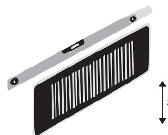
Die Magnetbefestigung ermöglicht eine präzise, jederzeit nachjustierbare Positionierung des Designgitters.
