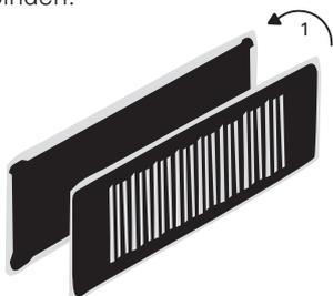
Designgitter und Montagerahmen verbinden sich mit Hilfe zweier Magnete schnell und einfach miteinander.
