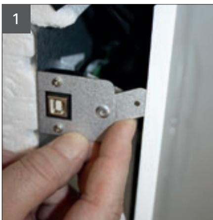
Sicherungsbügel der Platinenhalterung zur Seite drehen.
