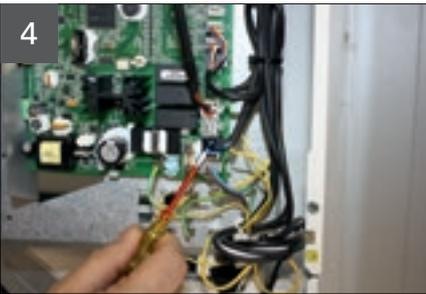
Klemme J6 - Netzanschluss Ventilator 1 (230 VAC) lösen.
