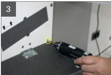
Beide Serviceklappen der Filter öffnen und die jeweils dahinterliegende Kreuzschlitzschraube (PH 2) entfernen.
