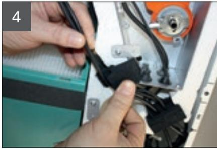
Abgeklemmte Kabel aus der Kabeldurchführung fädeln.
