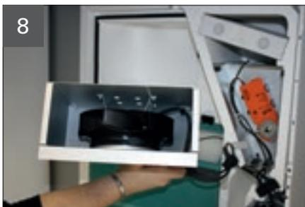
Nun muss der Ventilator aus dem Ventilatorgehäuse ausgebaut werden.
