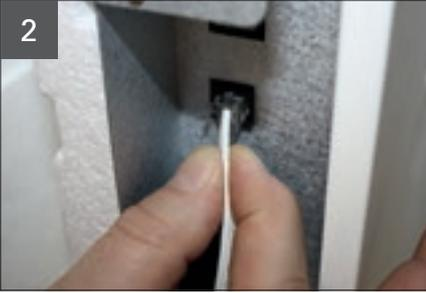
Anschluss des externen Bedienteils lösen.
