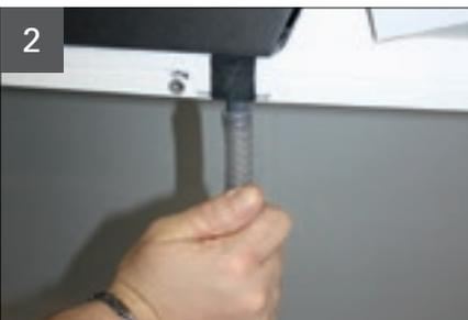
Schlauchselle lösen (Schraubendreher).
