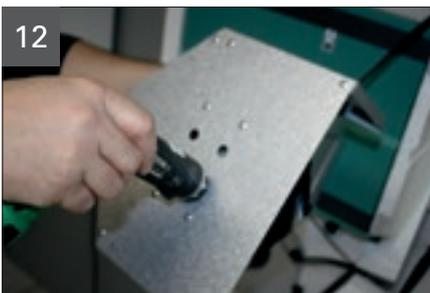
Auf der Rückseite des Ventilatorgehäuses die 4 innenliegende Schrauben lösen (Trox T20).
