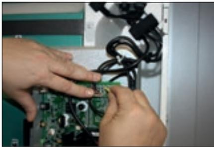
Die 4 Befestigungsclips vorsichtig lösen, Platine entfernen.
