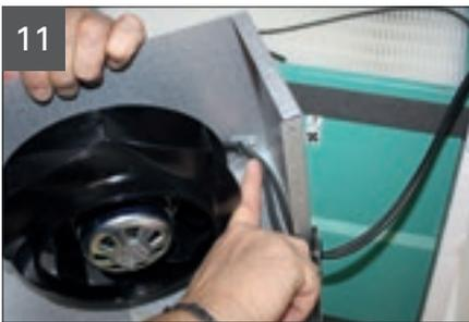
Kabelbinder lösen (Seitenschneider).
