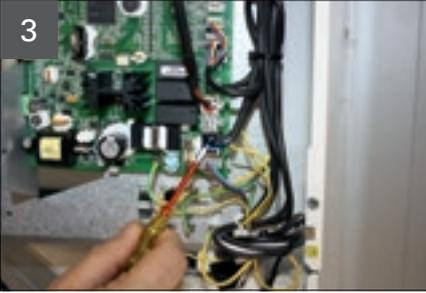
Klemme J2 - AC Netzspannung (230 VAC) lösen.
