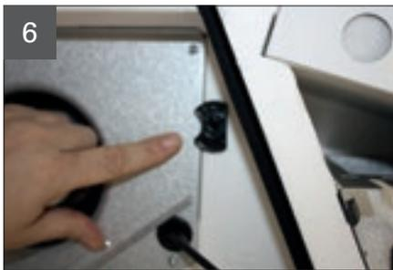
Ventilatorgehäuse ist mit zwei Sicherungshebeln gesichert. Die Sicherungshebel drehen, bis der Ventilator herausgezogen werden kann.
