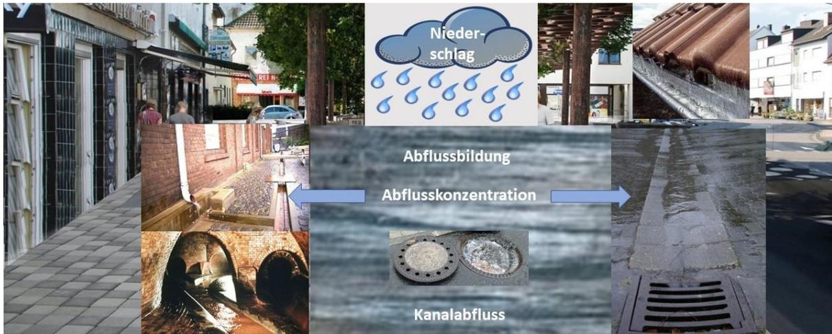
Abbildung 18: Phasen des Niederschlagsabflussvorganges in der Bebauung (eigene Darstellung)
