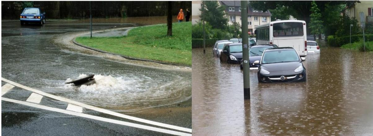
Abbildung 20: Wasseraustritt bei Schachtüberstau (links) und ausgeprägte Straßenüberflutung (rechts)
