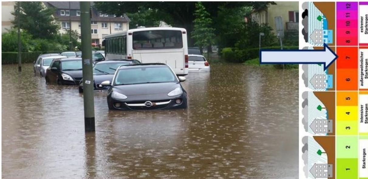
Abbildung 49: Starkregenüberflutung mit Einordnung der Regenstärke mit Starkregenindex SRI = 7
