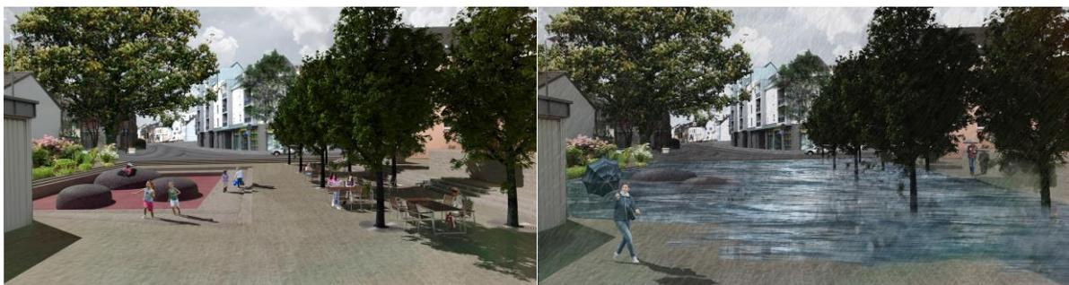
Abbildung 44: Mehrfachnutzung eines Platzes im urbanen Umfeld zum Rückhalt bei Starkregen (aus Benden et al. 2017)
