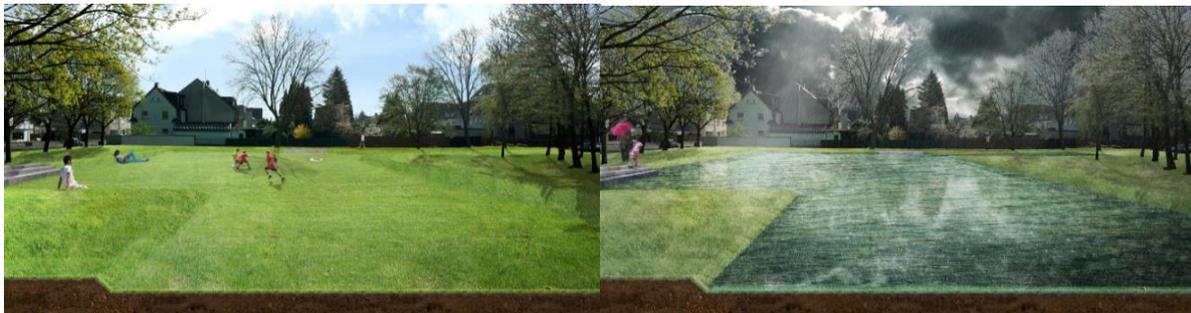
Abbildung 43: Mehrfachnutzung einer Grünfläche (Festwiese, Spiel- und Freizeitnutzung) zum Rückhalt bei Starkregen (aus Benden et al. 2017)
