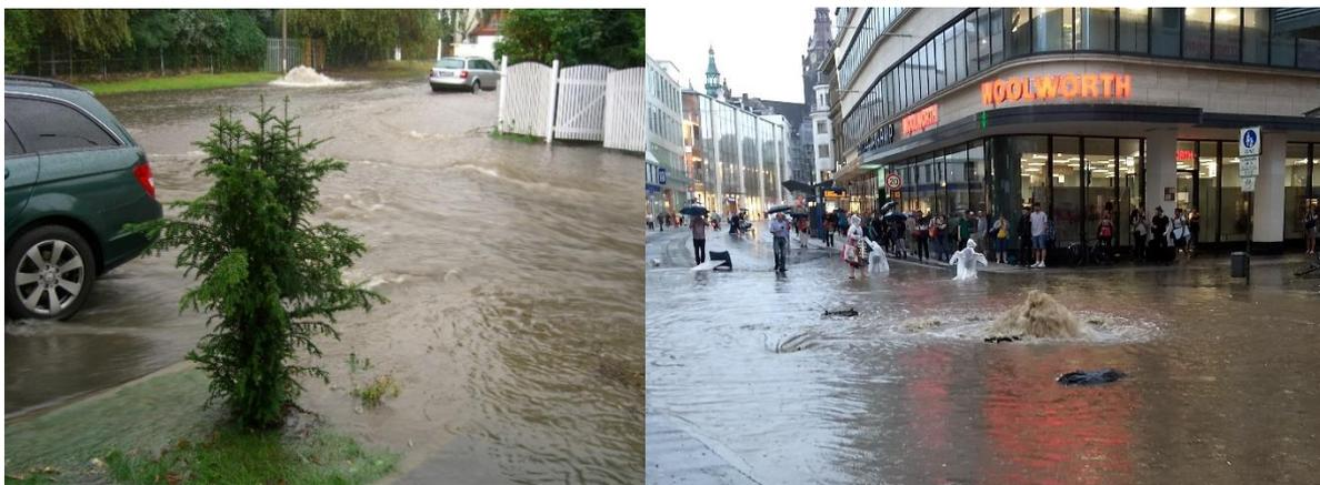
Abbildung 50: Überlagerung von oberflächiger Überflutung und Wasseraustritt aus der Kanalisation
