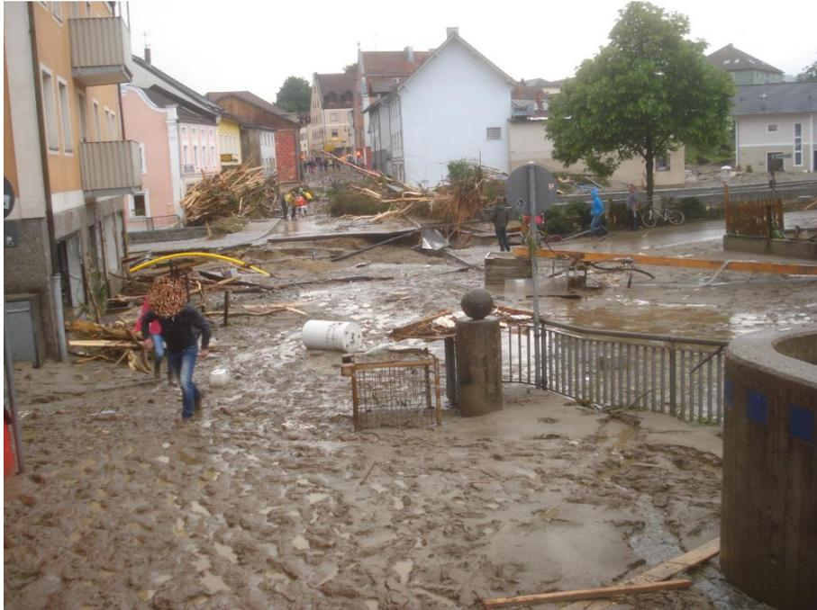
Abbildung 38: Verschlammung von Überflutungsbereichen in Simbach 2016 durch Außengebietszuflüsse (LfL 2021)
