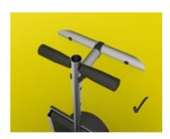
Hebestange mit Handgriff und der Drossel aus dem Schacht entnehmen. Handgriff demontieren. Haltestange an der Markierten Position ablängen (Säge oder Trennschleifer verwenden), Grate entfernen. Handgriff wieder montieren und Baugruppe in den Schacht einsetzen.
