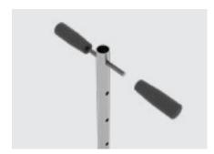
Die Montage der Schlauchdrossel erfolgt in wenigen Schritten. Zunächst wird der Handgriff in der letzten Bohrung der Hebestange montiert (Seite der Stange beachten).
