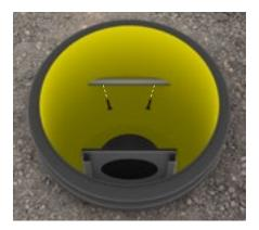
Haltevorrichtung für die Hebestange waagrecht und mittig über der Edelstahlgrundplatte positionieren und direkt in die Schachtwand, ohne Vorbohren verschrauben.
