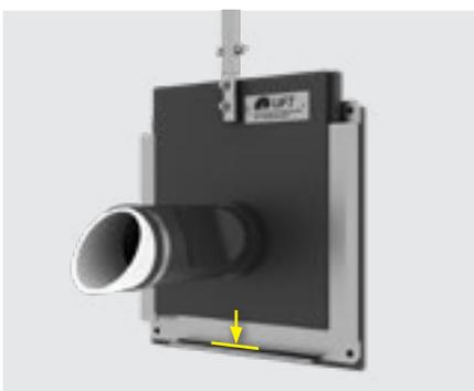
Anschließend wird das Drosselorgan mit der Hebestange in den Schacht eingeführt und die Steckplatte in die Führungen der Edelstahlgrundplatte eingeschoben. Es ist darauf zu achten, dass die Steckplatte bis auf den unteren Anschlagrand der Edelstahlgrundplatte geschoben wird.
