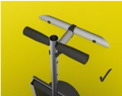
Hebestange mit Handgriff und der Drossel aus dem Schacht entnehmen. Handgriff demontieren. Haltestange an der Markierten Position ablängen (Säge oder Trennschleifer verwenden), Grate entfernen. Handgriff wieder montieren und Baugruppe in den Schacht einsetzen.
