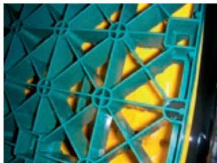
Gereinigte, rückstandsfreie Anlage, hier im Bereich Strömungstrenner
