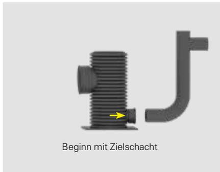
Der Ablauf ist zunächst ohne das Aufsetzrohr zu montieren. Hierzu werden das Rohrstück und der Bogen mit den Muffen wie dargestellt verbunden. Durch drehen des Anschluss T-Stückes wird der Ablaufwinkel realisiert. Die Richtung des Ablaufkanals gibt die Richtung vor.
