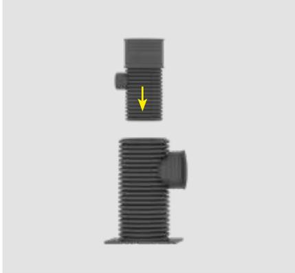
Die Höhenlage der Zulaufleitung ist gemäß Planungsvorgabe anzuschließen. Die Bauzeitenabdeckung des Schachtunterteils ist zu entfernen und anschließend auf die Muffe des Zulaufsets zu legen. Das Zulaufset wird in die obere Muffe des Startschachtunterteils montiert. Die werkseitig auf den Schachtzulauf bereits aufgelegte Muffe zur späteren Montage des Aufsetzrohres liegt dabei oben. Der Anschluss am Zulaufset ist mit der Richtung des Anschlusses von 180° an den Zulaufkanal anzubinden.
