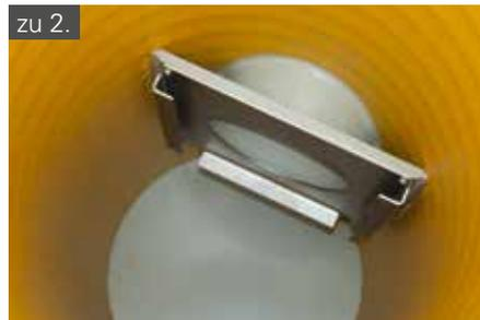
3. Danach kann das Ventil durch die Schachtöffnung eingeführt und mit der rechteckigen Grundplatte aus dunklem PE-HD-Kunststoff in die Edelstahlführung des abgehenden Rohrstutzens eingeführt werden. Das Ventil gleitet durch sein Eigengewicht ohne zu verkanten bis zum unteren Anschlag in die Führung. Die Handgriffe der Hebestange kommen dann in Höhe der Haltevorrichtung knapp unter der Schachtöffnung zu liegen.
