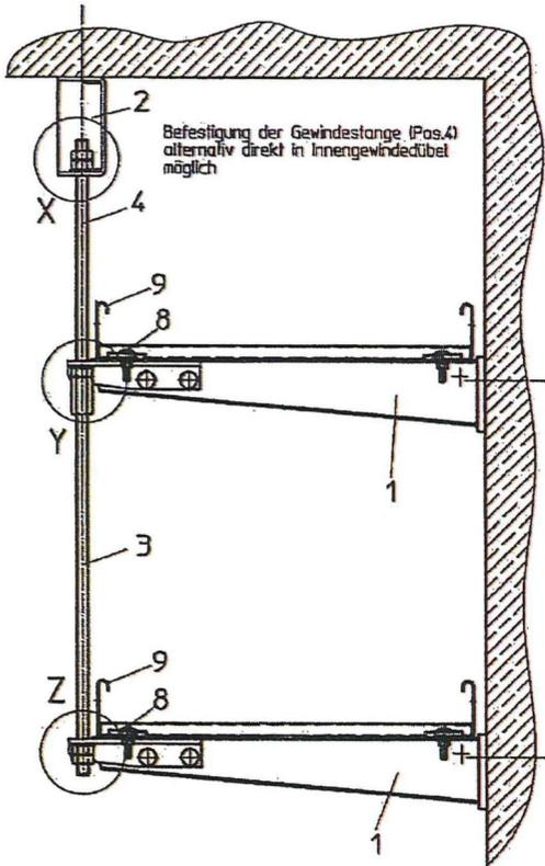
Befestigung der Gewindestange (Pos.4) alternativ direkt in Innengewindedübel möglich
