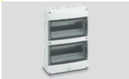
Kleinverteiler 2-reihig, 24 Teilungseinheiten, mit PE/N Klemme (je 2x16 mm<sup>2</sup>, 14x6 mm<sup>2</sup>), Vorprägungen unten/oben 1xM32/40, 2xM20/25, 8xM20, inkl. Zubehör
