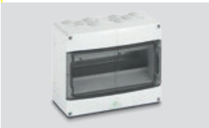
Kleinverteiler 1-reihig, 12 Teilungseinheiten, mit PE/N Klemme (je 2x16 mm<sup>2</sup>, 10x6 mm<sup>2</sup>), Vorprägungen unten/oben 1xM32/40, 2xM20/25, 8xM20, inkl. Zubehör
