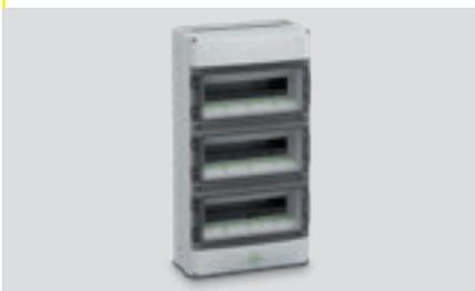
Kleinverteiler 3-reihig, 42 Teilungseinheiten, mit PE/N Klemme (je 6x16 mm<sup>2</sup>, 21x4 mm<sup>2</sup>), inkl. Belüftungselement, Flansche zusätzlich erforderlich
