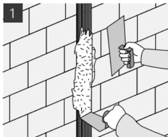
Das FFKu-ReMo click Wellrohr ist 50 cm vor und nach dem Brandriegel sowie zwischen dem untersten und 2. Brandriegel mit mindestens 15 mm dickem mineralischen Klebemörtel zu überdecken. Der unterste Brandriegel darf nicht verletzt werden, in diesem Bereich sind die Rohre im Mauerwerk zu verlegen.
