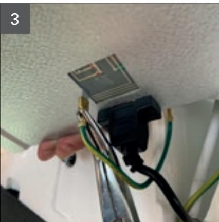
Schutzleiter auf der Rückseite der Bedieneinheit lösen.
