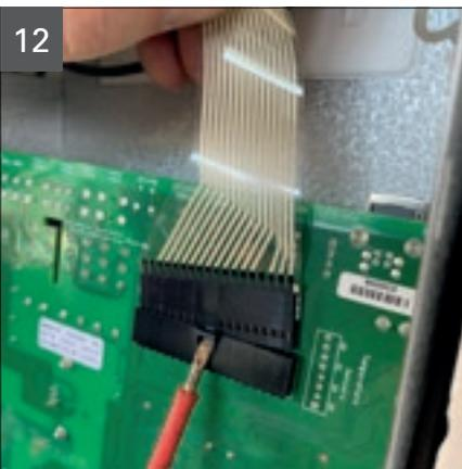
Lösen Sie vorsichtig das Flachbandkabel für die Bedieneinheit auf der Rückseite der Steuerplatine.
