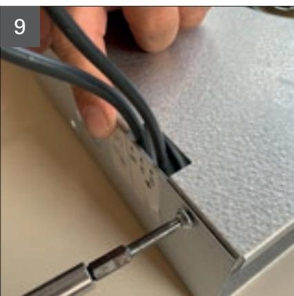
9 Lösen der seitlichen Gehäuseschrauben
