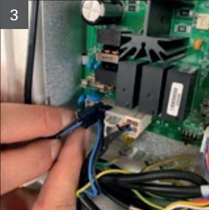
Klemme J4 – Netzanschluss Ventilator 1 (230 VAC) lösen.
