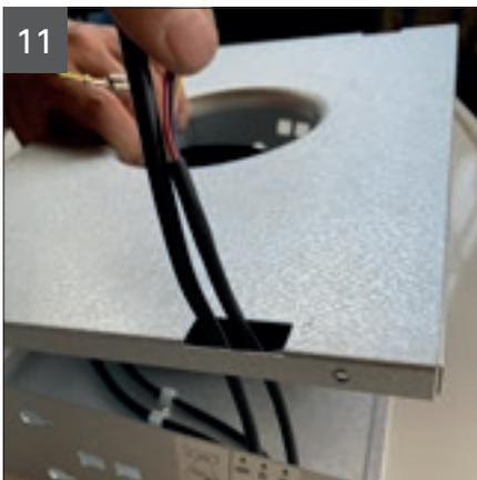
11 Gehäusedeckel abheben. Auf Kabel aufpassen,
