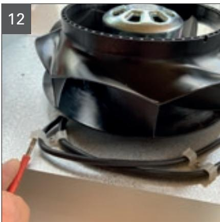
12 Kabelhalter leicht anheben und Kabel entfernen.
