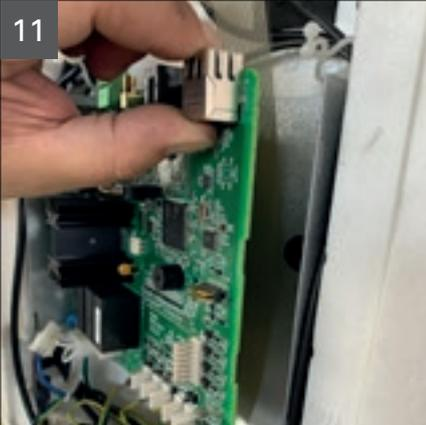
Die Steuerplatine vorsichtig aus dem Gehäuse heben.
