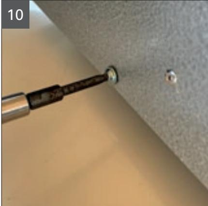
10 Lösen der Gehäuseschrauben auf der Rückseite
