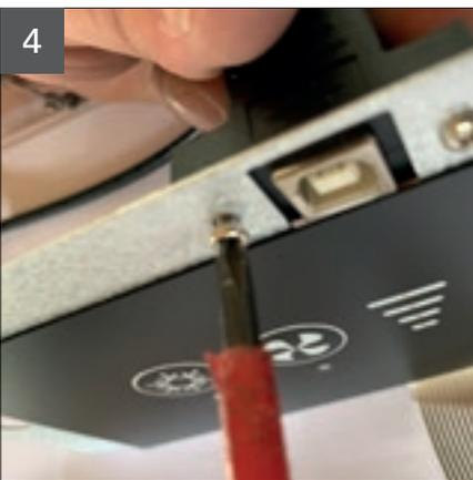
Befestigungsschrauben des USB-Anschlusses lösen.
