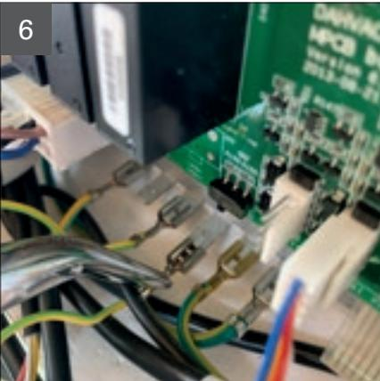
6 Abklemmen des entsprechenden PE Schutzleiters – Klemme am Metallgehäuse der Steuerplatine (unten)
