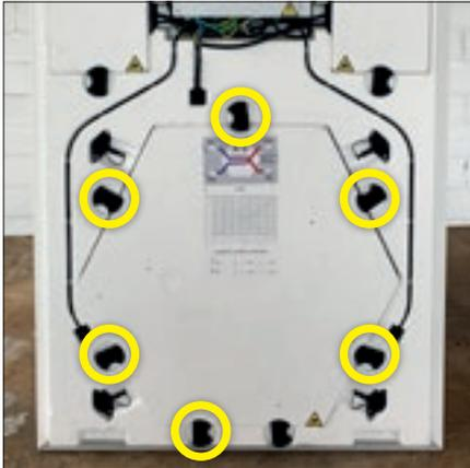
Position Verriegelungen Wärmetauscher
