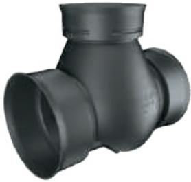
**Grundkörper-Innendurchmesser > 900 mm.** Spül- und Kontrollschacht aus PE-HD; monolithischer Grundkörper ohne Schweißnähte; Farbe schwarz; UV-beständig; Gewicht ca. 40 kg; extrem robust; schlag- und bruchunempfindlich von -20 °C bis +80 °C; beständig gegen Öle, Säure, Laugen, Fette, Benzin, Diesel nach DIN 8075 Beiblatt 1. Mit integrierter Setzungsreserve; Anschluss von Standardabdeckungen 625 mm.
