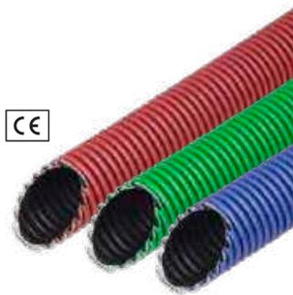
Kabelschutzrohr aus PE in Verbundrohrbauweise (außen gewellt, innen glatt) nach DIN EN 61386-24 mit Muffe (sanddichte Ausführung), halogenfrei, Sonderfarben. Hohe Scheiteldruck- und Schlagfestigkeit sowie Biegefähigkeit. Druckbeanspruchung Typ 450, Klassifizierungscode N450. Doppelsteckmuffen für sanddichte Verbindungen (SD). Mit Profildichtringen wasserdichte Verbindung (WD).
