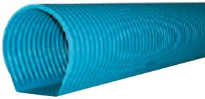
Teilsicker- und Mehrzweckrohre aus PVC-U nach DIN 4262-1 Typ C1 (vormals Form F), Wassereintrittsfläche  $\geq 50 \text{ cm}^2/\text{m}$ , Schlitzbreite  $1,2 \text{ mm} \pm 0,4 \text{ mm}$ . Entsprechend REwS (Richtlinien für die Entwässerung von Straßen) einsetzbar, SN 4 nach DIN EN ISO 9969.
