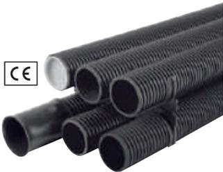
Kabelschutzrohr aus PE in Verbundrohrbauweise (außen gewellt, innen glatt) nach DIN EN 61386-24 mit Muffe (sanddichte Ausführung), halogenfrei, Farbe schwarz. Hohe Scheiteldruck- und Schlagfestigkeit sowie Biegefähigkeit. Druckbeanspruchung Typ 450, Klassifizierungscode N450. Doppelsteckmuffen für sanddichte Verbindungen (SD). Mit Profildichtringen wasserdichte Verbindung (WD).
