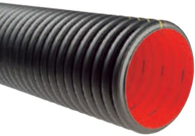
Teilsicker-, Vollsicker- und Mehrzweckrohr SN 16 aus PP in bewährter Verbundrohrbauweise (außen gewellt, innen glatt), gemäß DIN 4262-1 Typ R2 und DIN 13476. Erfüllt die speziellen Anforderungen der DBS 918064 (Stand 08/2022) der Deutschen Bahn AG. Besitzt die Herstellerbezogenen Produktqualifikationen (HPQ) für alle Druckbereiche.
