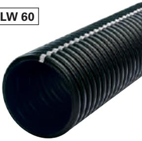
Teilsicker-, Vollsicker- und Mehrzweckrohre aus PE-HD nach DIN 4262-1, Typ R2, Wassereintrittsfläche  $\geq 50 \text{ cm}^2/\text{m}$  für LP, TP, MP, Schlitzbreite  $1,2 \text{ mm} \pm 0,4 \text{ mm}$ . Entsprechend REwS (Richtlinien für die Entwässerung von Straßen) einsetzbar; SN 4 nach DIN EN ISO 9969.
