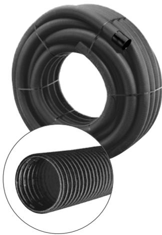
Gewelltes Vollsickerrohr aus PE; Farbe schwarz mit gelber Farbmarkierung; Ringsteifigkeitsklasse SN 8; Schlitzfläche  $\geq 50 \text{ cm}^2/\text{m}$ ; Schlitzbreite 1,2 mm. In Anlehnung an DIN 1187 und DIN 4262-1.
