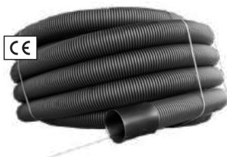
Kabelschutzrohr aus PE in Verbundrohrbauweise (außen gewellt mit Innenrohr) nach DIN EN 61386-24 mit Muffe (sanddichte Ausführung), halogenfrei, Farbe schwarz. Flexibel, in Ringen, mit Einzugschnur. Hohe Scheiteldruck- und Schlagfestigkeit sowie Biegefähigkeit. Druckbeanspruchung Typ 450, Klassifizierungscode N450. Doppelsteckmuffen für sanddichte Verbindungen (SD). Mit Profildichtringen wasserdichte Verbindung (WD).
