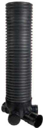
Kompakter Spül- und Kontrollschacht aus PE-HD; bestehend aus Schachtunterteil und Aufsetzrohr  $D_A$  400; Farbe schwarz. UV-beständig; beständig gegen Öle, Säure, Laugen, Fette, Benzin, Diesel nach DIN 8075 Beiblatt 1; wasserdicht gemäß DIN 4262-1. Einbau in Verkehrsflächen möglich; 180° Durchgangsschacht zum direkten Anschluss von Strabusil DN 150 bzw. StormPipe DN 150 (auch mit Dichtring).
