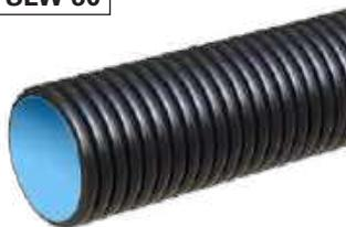
Transportrohr aus PE-HD in Verbundrohrbauweise (außen gewellt, innen glatt), einschließlich Dichtring und Muffe. Außen schwarz, innen blau. Extrem belastbar (SN 8 nach DIN EN ISO 9969). Entsprechend REwS (Richtlinien für die Entwässerung von Straßen) einsetzbar.
