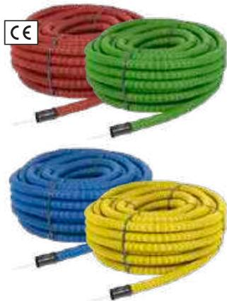
Kabelschutzrohr aus PE in Verbundrohrbauweise (außen gewellt mit Innenrohr) nach DIN EN 61386-24 mit Muffe (sanddichte Ausführung), halogenfrei, Sonderfarben. Flexibel, in Ringen, mit Einzugschnur. Hohe Scheiteldruck- und Schlagfestigkeit sowie Biegefähigkeit. Druckbeanspruchung Typ 450, Klassifizierungscode N450. Doppelsteckmuffen für sanddichte Verbindungen (SD). Mit Profildichtringen wasserdichte Verbindung (WD).
