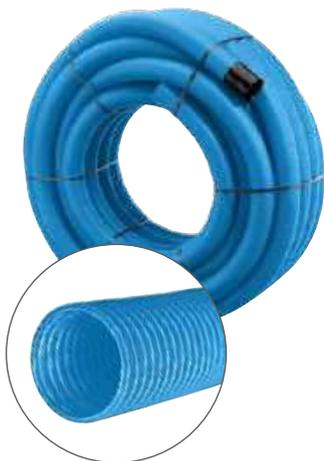
Gewelltes ungelochtes Dränagerohr aus PP; Farbe blau; Ringsteifigkeit  $\geq 10 \text{ kN/m}^2$  („SN 10“); in Anlehnung an DIN 1187 und DIN 4262-1.
