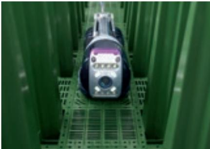
Pour l'inspection de l'ouvrage, il suffit d'utiliser une caméra standard. Une caméra à tête pivotante et réglable en hauteur apportera une meilleure visibilité et une vue latérale de l'ouvrage ; un dispositif dirigeable permettra une position centrale de l'appareil pour une optique et un éclairage plus performants afin de garantir une image parfaite.
