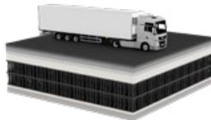
La chambre modulaire Rigofill ST-B supporte des charges roulantes allant jusqu'à PL 60 / LGV 60 et convient, par conséquent, à la construction d'installations situées sous des espaces verts ou aires de stationnement. Avec les paramètres de montage courants\*, les installations d'infiltration autorisent des hauteurs de recouvrement  $H_0$  de 2,3 m et des profondeurs  $T_s$  de 4 m.
