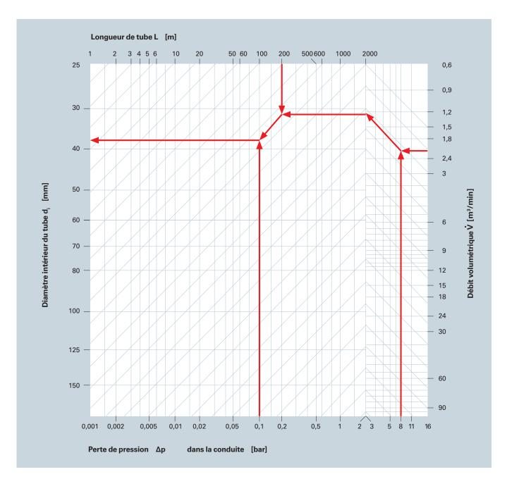
**Exemple:** le tube choisi a un diamètre de DN  $40 \triangleq 50 \times 4$
