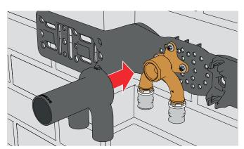
Dispositif d'étanchéité alpex pour coude à applique double
