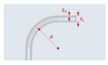
Les rayons de cintrage minimum R (cf. schéma à gauche et tableau ci-dessous) doivent être respectés. Les raccords alpex ne doivent pas être utilisés comme outil de cintrage du tube ; ils ne peuvent être installés qu'une fois le tube cintré.
