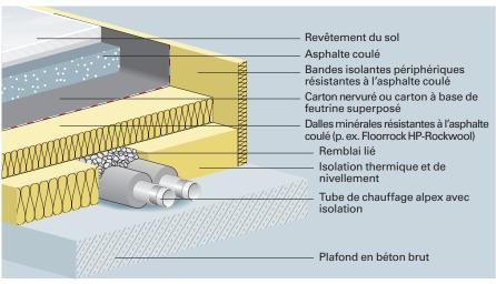
Structure du sol sous asphalte coulé
