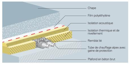
Structure du sol sous la chape avec tube alpex pré-isolé
