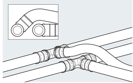
Montage de raccords en té dans un système alpex
