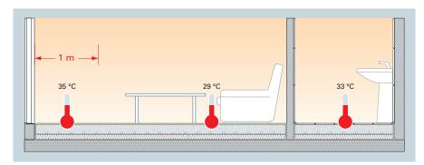
Températures de surface maximales dans des pièces avec sol chauffé.
