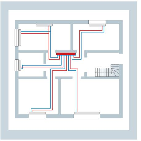
Plan avec pose de radiateurs
