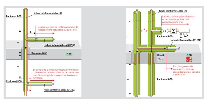
Conduites de raccordement dans des colonnes montantes avec isolation de la traversée avec R 30, si une longueur d'isolation minimale L est maintenue des deux côtés de la pénétration ( $L \ge 500$  mm).
