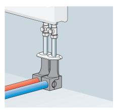
Raccordement unique alpex du collecteur avec coude de raccordement du radiateur
