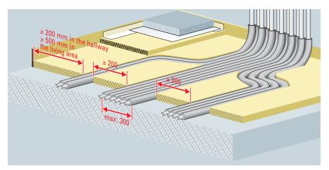
Largeurs des tracés de conduites et largeurs des surfaces d'appui
