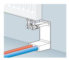
Raccordement unique alpex du collecteur avec bloc de raccordement du radiateur
