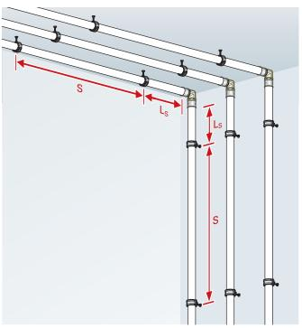
Toutes les conduites doivent être installées de telle sorte que l'expansion thermique en longueur ne soit pas entravée ; cf. expansion thermique en longueur.
