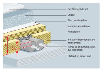
Structure du sol avec isolation du tube
