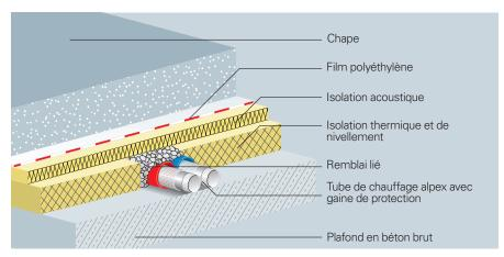
Structure du sol sous la chape avec tube alpex et gaine de protection appropriée
