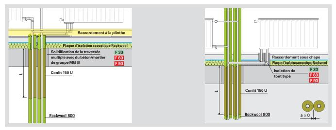
Cloisonnements R 30 à R 90 de conduites de raccordement de radiateurs en tube composite métallique d  $\leq$  63 mm, si une longueur d'isolation minimale L est maintenue sur un côté de la traversée (L  $\geq$  1000 mm).
