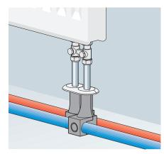
Conduite en boucle avec raccordement de radiateur
